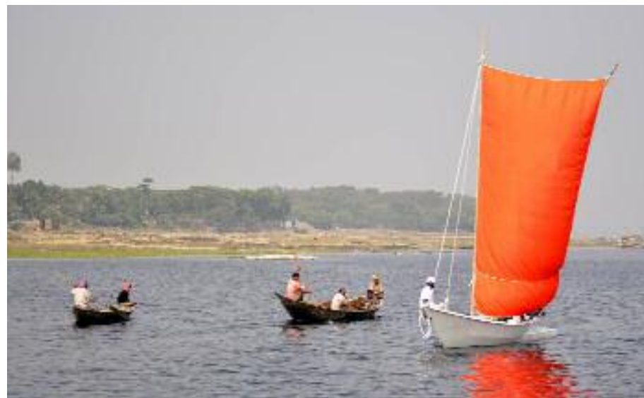
Ci-dessus: les bateaux de pêche «masdoris», construits par l'ONG Friendship en fibre de verre, remplacent avantageusement les embarcations traditionnelles en bois, d'une durée de vie très limitée. Leur forme n'est pas sans rappeler celle de Tara Tari .
