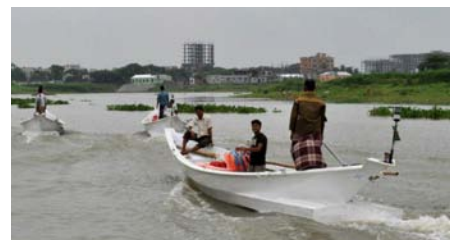
Ci-dessus: les bateaux de pêche «masdoris», construits par l'ONG Friendship en fibre de verre, remplacent avantageusement les embarcations traditionnelles en bois, d'une durée de vie très limitée. Leur forme n'est pas sans rappeler celle de Tara Tari .
