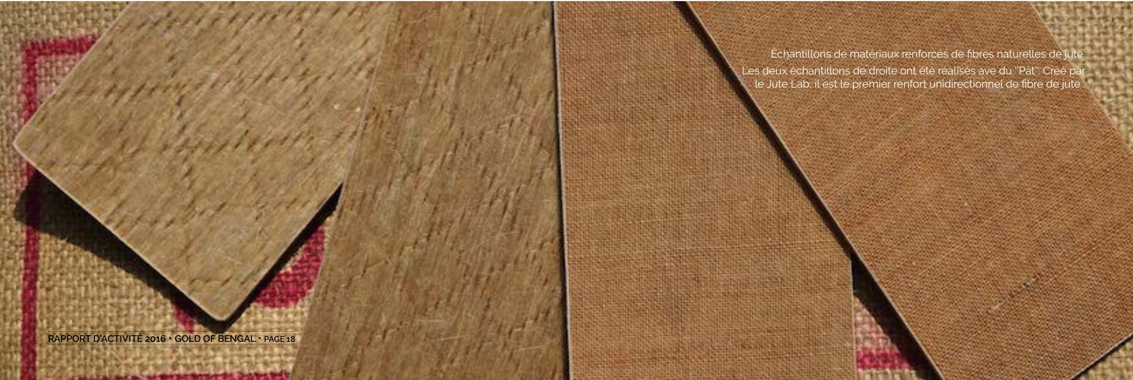
Échantillons de matériaux renforcés de fibres naturelles de jute. Les deux échantillons de droite ont été réalisés avec du "Pât". Créé par le Jute Lab, il est le premier renfort unidirectionnel de fibre de jute.
