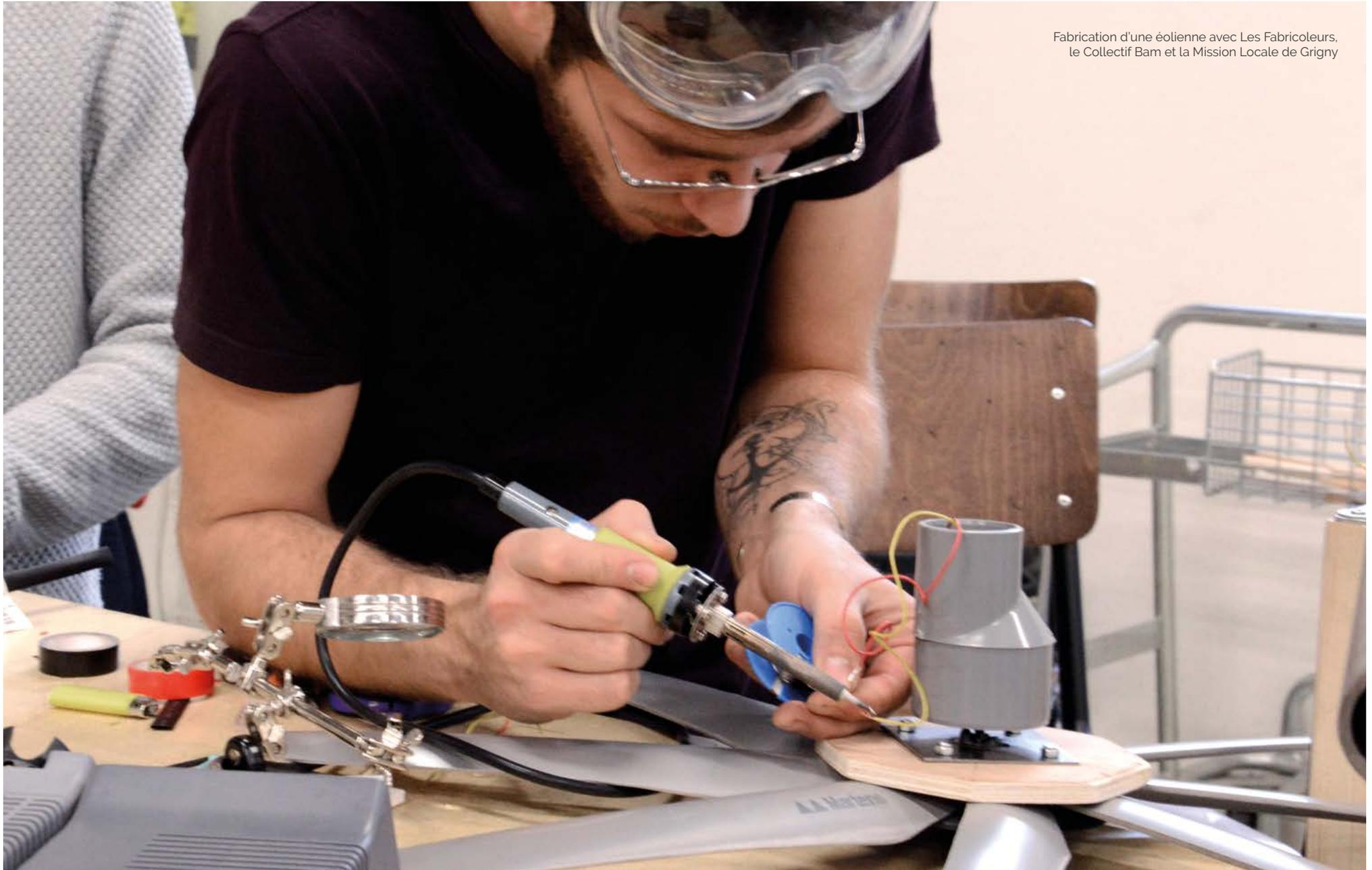
Fabrication d'une éolienne avec Les Fabricateurs, le Collectif Bam et la Mission Locale de Grigny
