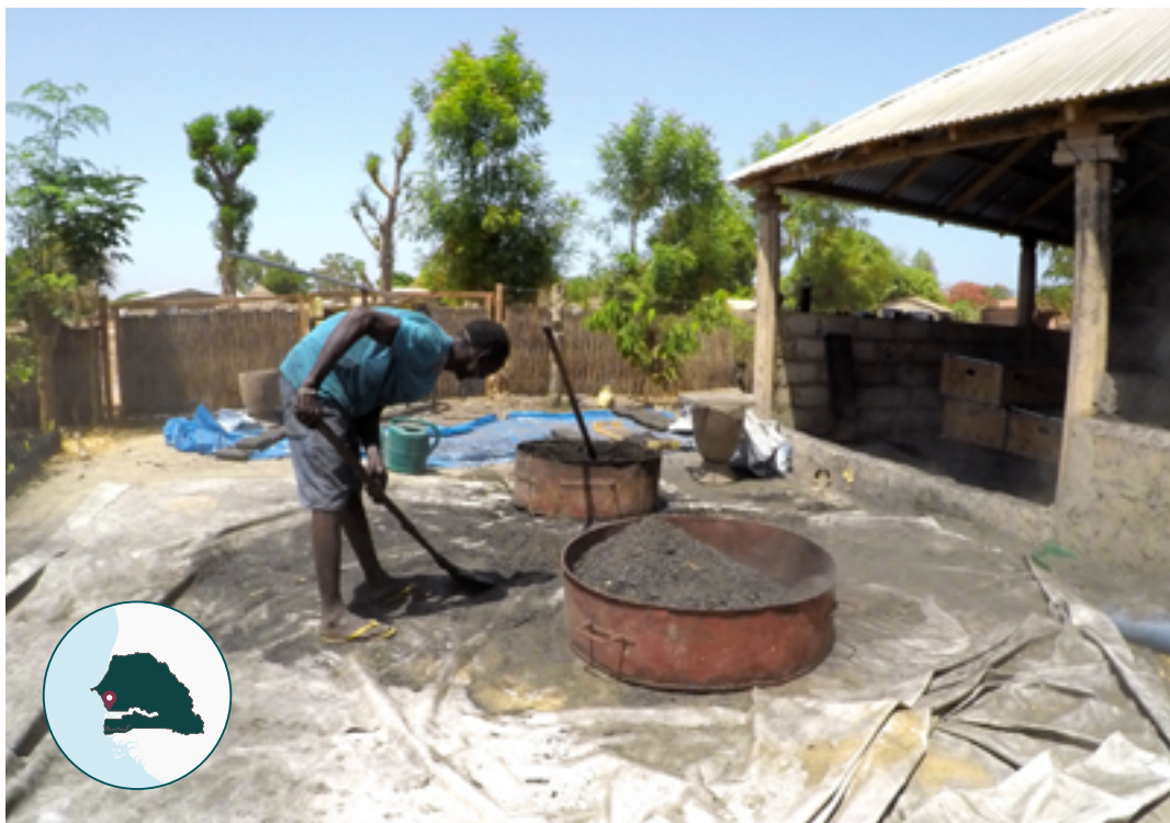
Légende: fabrication de charbon de paille
